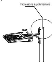
Si le luminaire est installé sur un poteau de lampe carré, installer l'accessoire supplémentaire avant l'étape 4 ci-dessus; les autres instructions seront les mêmes
