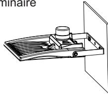
3. Placer le cordon au travers du support de montage à linteau, et connecter les fils
