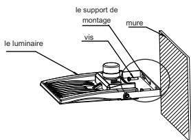
2. Installer le support de montage à linteau sur le luminaire
