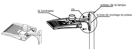
2. Fixer solidement le bras de montage du poteau au luminaire
