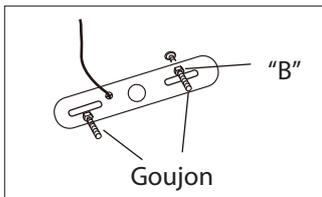
**1.** Dévissez l'écrou B. Ajustez le poteau à la longueur désirée et barrez en place avec cet écrou.
