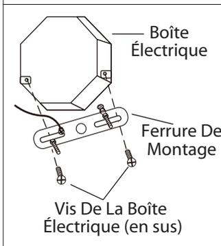
**2.** Posez la ferrure d'installation à la boîte de sortie électrique à l'aide des vis de la boîte (en sus). Assurez-vous que les goujons de la ferrure d'installation font face vers l'extérieur de la boîte électrique.
