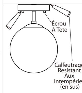
**8.** Placez la plaque de la douille et fixez le couvercle à l'aide de l'écrou.
