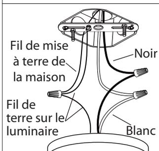
**3.** Branchez les fils de la mise a terre (cuivre nu ou vert) de votre luminaire au fil de la mise A terre (cuivre nu ou vert) ou vis de la mise a terre dans la boîte électrique. Posez le fil noir (ou fil ayant un écriteau) de la fixture au fil noir dans la boîte électrique et posez le fil blanc de la fixture au fil blanc dans la boîte.
